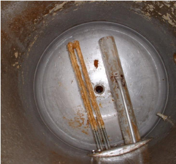
Pulverförmiger Kalk, welcher am Boden des Heizkessels lag.
