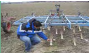
Produktionsleiter Fernando zeigt die Arbeitstiefe am Grubber.
